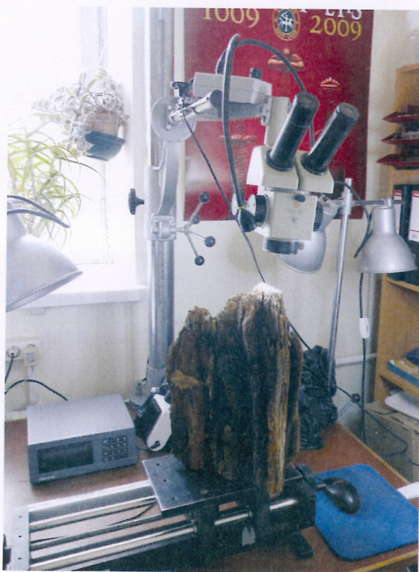
3 pav. Rėvių pločių matavimas rąsto gale.
